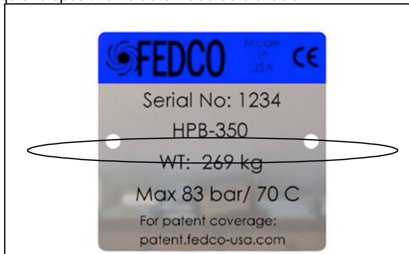
Figura 6 – Placa de identificación de la unidad HPB
